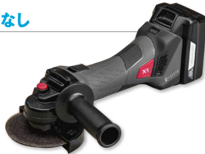
本体の側面についたボタンで、回転数を3000、6000、8000min -1 と3段階に切り替え可能
