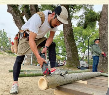
丸ノコで対応できない場所はマルチツールにお任せ。刃が微振動しながら切り欠きができるので、細かい箇所の工作には最適。
