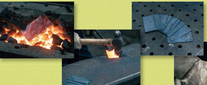
鐵板は一枚一枚を何度も火にかけ、ハンマーで叩いてフラットに整え、成型する。仕上げにディスクグラインダーでバリを取り、角を丸める。
