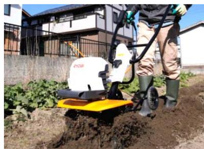
刃には、曲げ加工を施した、強度のある鍛造品のナタ爪を採用しました。効率よく土をかき混ぜて、しっかり耕すことができます。
