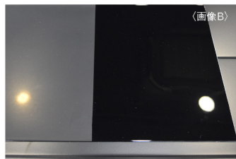
トヨタ純正#202ブラックを塗装したパネル。左は2500#のペーパーを掛けたもの。右側がPEG-132と推奨する組み合わせでの左の状態から磨いた結果。磨きの仕上がりが
