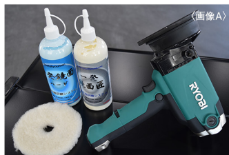
テスト結果から導き出された、磨き作業に最適な組み合わせ(PEG-132、一発鏡面「ハード」、ロングウールパフ)。最終仕上げ用には、一発鏡面「匠」を使い分けたい
