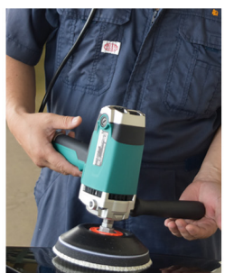
機械を“置いた”状態。ご覧のように抜群のバランスで塗装面に平らに当てても踊ることが少ない
