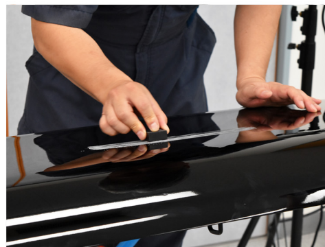
トヨタ純正の#202ブラックのフードパネルに1500#のペーパーでキズを付ける
