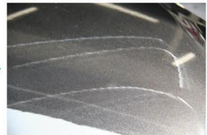
傷はほぼ消えたものの、シングルアクションポリッシャーによるバフ目が残っている
