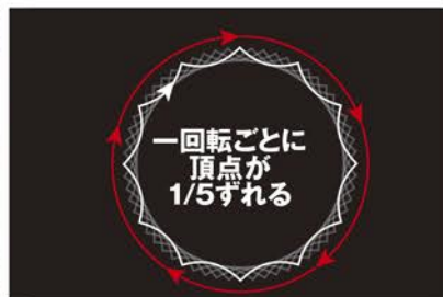
従来のギヤアクションと異なり一回転ごとに軌跡が変わるリョービ独自の機構（特許出願中）
