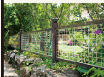
支柱サイズは市販のSPF材では見られない70mm角程度。全体のバランスに合わせてサイズを調節できるのが自動カンナの強み
