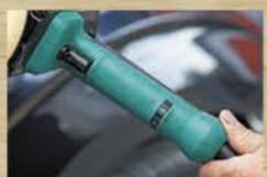
**変速ダイヤル付**で適切な回転数に設定
