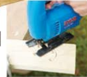
天板にドリルで4カ所穴をあ けて、それらをつなぐように ジグソーで丸くくり抜きます。
