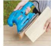
サンダーで全体を軽く研磨し、 角をなめらかに。穴の内側も サンドペーパーできれい。
