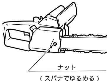
2. 付属品の ⊖ドライバーでチェーン引ネジを回し、ソーチェーンの張りを調整します。チェーン引ネジを右に回すとソーチェーンは張り、左に回すとゆるみます。
