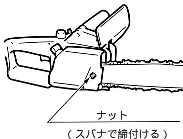
(注) 新品時のソーチェーンは多少の伸びがありますので、少し使用ののち、点検をしてください。必ず電源からプラグを抜いて調整を行なってください。
