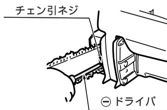
3. ソーチェーンの張りはガイドバーの中ほどでソーチェーンを軽く指で引上げ、ドライプリングの底がガイドバーから 1 ~ 2mm 離れる程度に調整してください。
