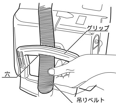
2. 吊りベルトを締め具の上に通します。
