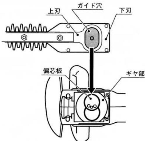
(注) 取付けの際、ガイド穴部分に少量のグリスを塗布してください。また、ブレード部には機械油などの粘度の低い油を塗ってください。
