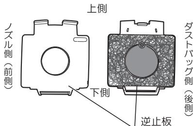
1. ダストバッグカバーを取外します。
