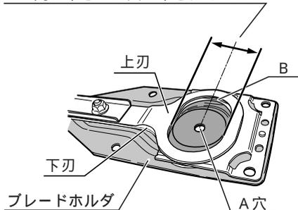
・本体の偏心板を手で回して、右図のようにイのラインと偏心板の2つの円を平行に合わせます。
