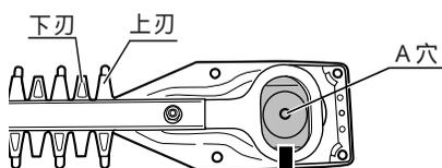
(注) 本体にブレードセットを取付ける前に、ア矢印位置(4ヶ所)にあるブレード固定ネジ用のナットを確認し、奥まで押込んでください。
