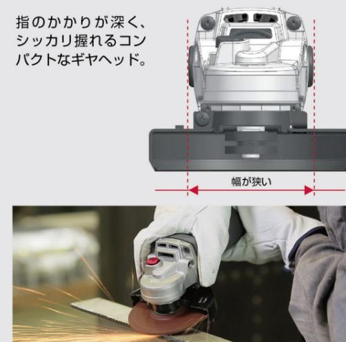
ギヤヘッド高さを従来モデルに比べ5mm低くしたことにより今まで研磨作業ができなかった狭所にも対応。(RG1262/RG1264は除く。RG1262/RG1264は従来機より7mm低い62mm)
