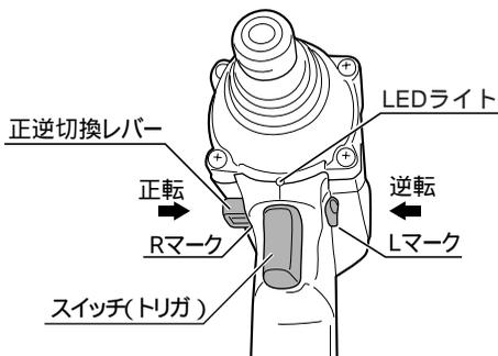
（注）トリガの引込み量が少ない状態（低速回転域）で回転を停止させる作業を連続的に行ないますと、スイッチ変速回路の温度上昇による回路焼損の原因となります。
