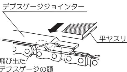
2 溝から出ている部分を平ヤスリで削り落とし、適切なデブスゲージ高さに調整します。ヤスリを往復で使用すると、平ヤスリの目が早くつぶれますので、必ず一方向のみに動かして研磨してください。
