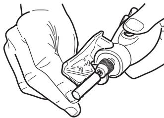
5. 取外しは、ロックボタンを押さえ、回転軸を固定し、片ロスパナでコレットチャックをゆるめてから砥石軸を抜いてください。
