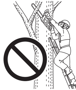
はしごを使用した作業は危険です
