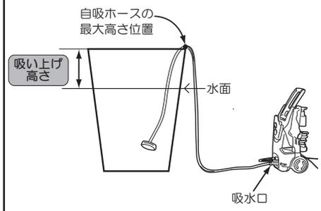
吸水口の高さが自吸ホースの最大高さと同じ時の吸い上げ高さは、吸水口から水面までをさします。
