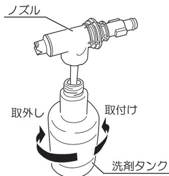
2. ガン凹部に洗剤噴射ノズル凸部を合わせてさし込みます。
