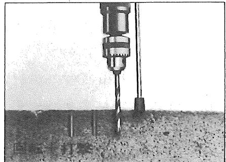
震動ドリルとして、コンクリート、タイル、石材等硬質材料の穴あけ作業に（ストッパーで定寸深サ加工を、アンカーの打込み深サが一定に決まります。
