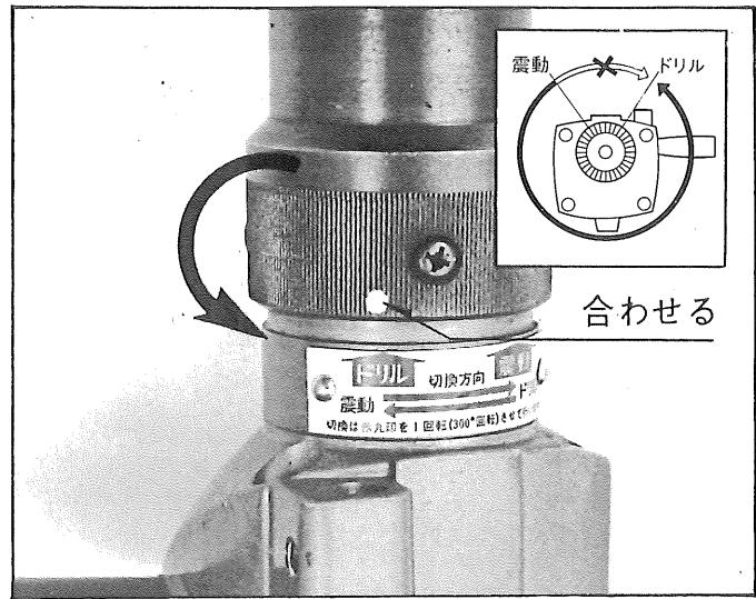
2. 下ドリルの所に合せ電気ドリルとして使用します。
