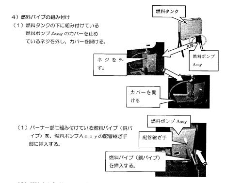
(2) 燃料パイプに付いているナットを配管継ぎ手のネジ部に取り付け、継ぎ手部の六角 及び燃料パイプのナットにスパナ(サイズ: 12mm)を使用し、継ぎ手部を固定し燃料パ イプのナットを右に回し固定します。 継ぎ手部のスパナは、継ぎ手が
