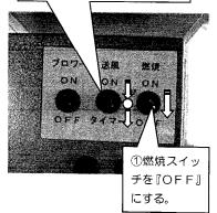
(3)燃料バルブを全閉後、電源プラグを電源から抜く。
