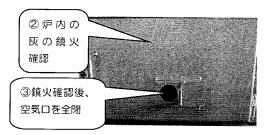
(2) バーナーの燃焼スイッチを『OF F』にします。このとき念のため煙突から煙の出ていないことを確認してください。続いて送風スイッチを『タイマー』にセットします。自動的に60分間送風運転が行われ、その後停止します。(煙が出ている場合は再度送風スイッチを『ON』にし、続いて燃焼スイッチをONにし、煙が出なくなるまで2次燃焼を行います。)
