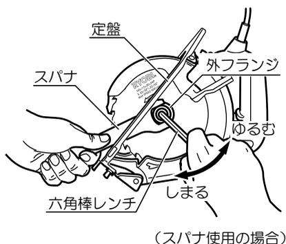
④ 固定ボルト、外フランジを外します
