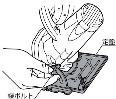
(注) 傾斜させて切込深さを最大にし、そのまま 0° に戻した場合、刃物と定盤が直角にならないことがあります。その場合は、少し切込深さを浅くして直角調整を行ない、その後、切込深さを調整してください。
