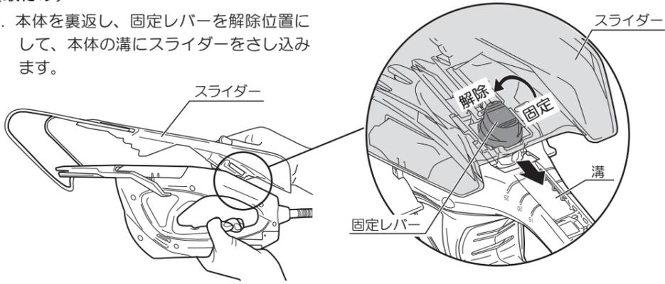
2. 固定レバーを持ちながら矢印の方向にスライドさせて取付けます。
