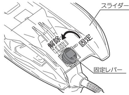
2. 固定レバーを押さえながら、矢印の方向にスライドさせて取外します。
