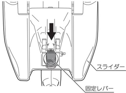
3. 作業中にスライダが外れないように固定レバーを“解除”から“固定”に切替えます。
