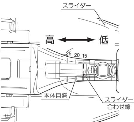
4. 作業中に刈込み高さが変わらないように固定レバーを“解除”から“固定”に切替えます。
