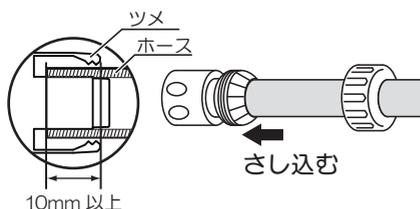
4. リングを回してしっかり締付けると、ツメで吸水ホースが固定されます。
