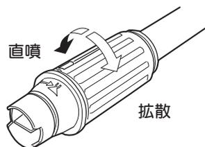
直噴洗浄…… 水流が直線上に噴射します。こびり付いた汚れに適しています。
