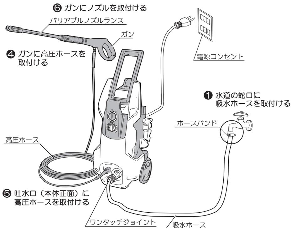
② 吸水ホースにワンタッチジョイントを取付ける
