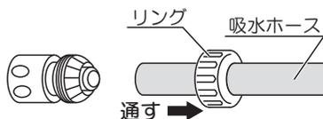
3. 吸水ホースを図のようにワンタッチジョイントのツメの先端から10mm以上さし込みます。
