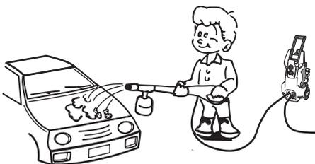
※ 吐出圧調節ダイヤルを最大にしても洗剤噴射ノズルからは低圧で噴射されます。
