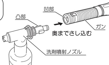
3. 洗剤噴射ノズルは必ずガンの奥までさし込んだ状態でガンを矢印の方向に止まるまで回してください。
