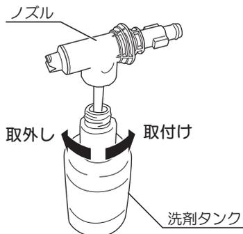
2. ガン凹部に洗剤噴射ノズル凸部を合わせてさし込みます。
