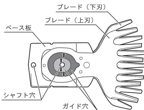
3. 2本のギヤ用シャフトと偏芯板をベース板のシャフト穴およびブレードのガイド穴に合わせてブレードを取付けます。ベース板に2本のギヤ用シャフトが確実に納まっていることを確認してください。
