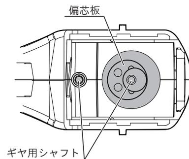
2. シャフト穴に対してガイド穴が左右対象になるようにブレードとベース板を動かして合わせます。
