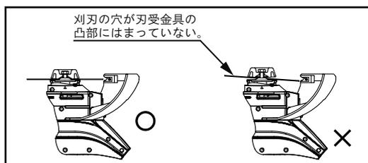
その後ボルトカバー、押えボルトを取付けてください。
