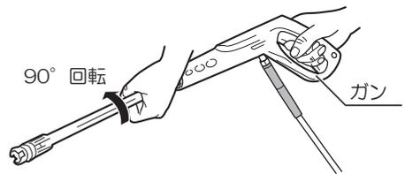
⚠ 回転ブラシなどアクセサリをガンの先端にナットで固定するものは、上記方法で角度を変更できません。ナットをゆるめてから角度を変更し、変更後は、確実にナットを締付けてください。
