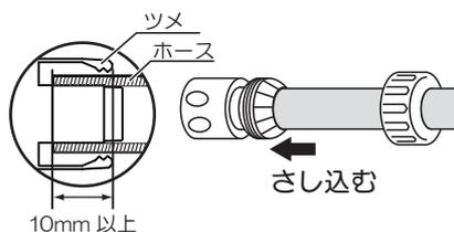
4. リングを回してしっかり締付けると、ツメで吸水ホースが固定されます。
