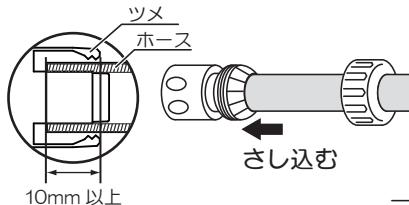
4. リングを回してしっかりと締付けると、ツメで吸水ホースが固定されます。
