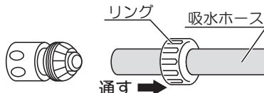
3. 吸水ホースを図のようにワンタッチジョイントのツメの先端から 10mm 以上さし込みます。
