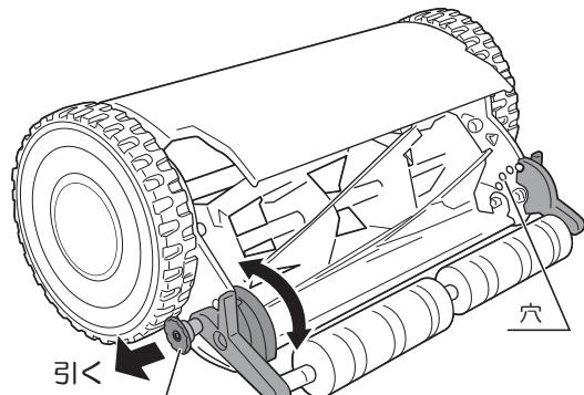
2. 左右とも同じ高さになるように刈込み高さ調節ツマミを固定します。
