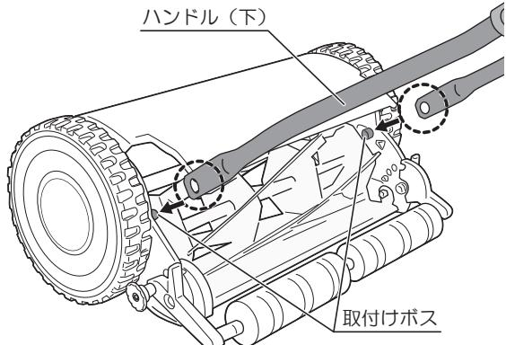
5. ハンドルを取付けた後、下図のように取付けボスの穴にRタイプピンを差し込んで抜け止めをしてください。（左右2ヶ所）
