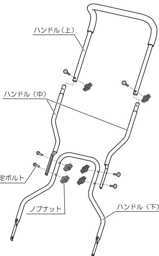
4. ハンドル（下）にある穴を本体の内側にある取付けボスに確実にはめ込みます。
