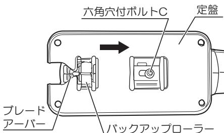
3. ブレードをブレードアーバーの溝の奥までさし込み、六角穴付ボルトAを軽く締付け、次に六角穴付ボルトB、Aの順に六角棒レンチで締付けます。
