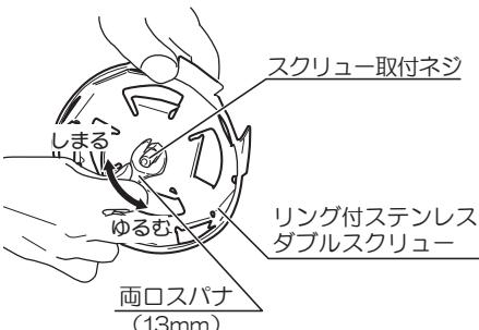
スピンドルを両口スパナの17mm側で固定し、スクリュー取付ネジの六角部を両口スパナの13mm側で締付けてください。
