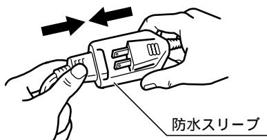
(注) 延長コードは、出来るだけ太く短い工業用のキャブタイヤコードをご使用ください。長すぎる延長コードは電圧の降下により、十分な性能が発揮されないだけでなく、モーター焼けの原因にもなります。
