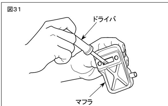
1. マフラを外して、排気口にドライバを入れてカーボンを落してください。同時にマフラ出口のカーボンも落してください。
