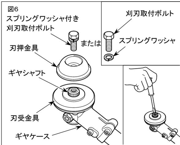
4. スプリングワッシャ付き刈刃取付ボルト（または刈刃取付ボルトとスプリングワッシャ）および刃押金具を外してください。
