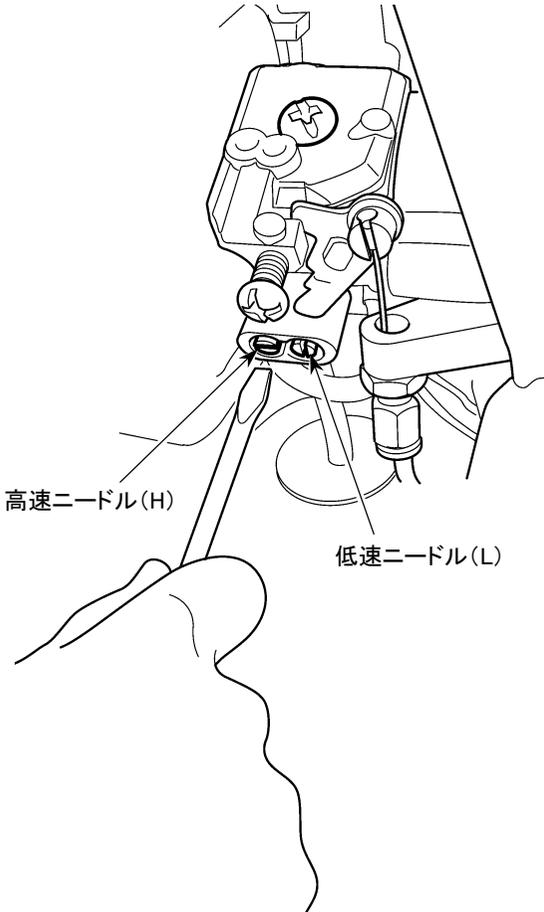
1. エンジン停止状態で燃料ニードルを基準開度にセットします。
