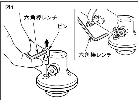
1. 付属品の六角棒レンチをピンの穴に差し込み、引き抜いてください。
