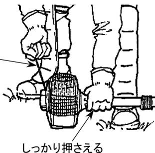
5. 機体を安定した地面に置き、刈刃の周囲の安全を確認してから、左手でクラッチハウジングを押えながら右手でスタータノブを引いてください。
