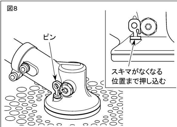
10. ピンをギヤケースの差込穴に押し込み、確実に固定されていることを確認してください。
