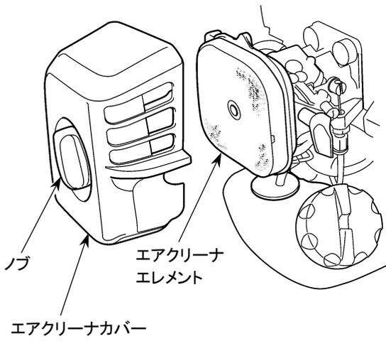
25時間使用毎を目安にエアクリーナカバーのノブをゆるめてカバーを取り外し、内部のゴミを取り除いてください。
