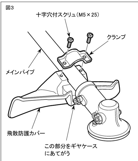
付属の飛散防護カバーの先端をギヤケースにあて、付属のクランプでメインパイプに取り付け、十字穴付スクリュ (M5 × 25) 2本で均等に締め付けてください。
