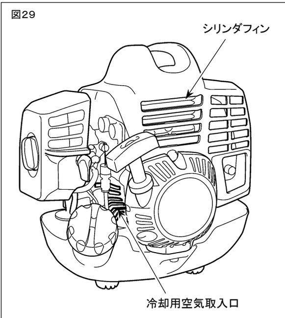
25時間使用毎に冷却用空気取入口やシリンダの冷却フィン回りを点検し、付着したゴミを取り除いてください。
