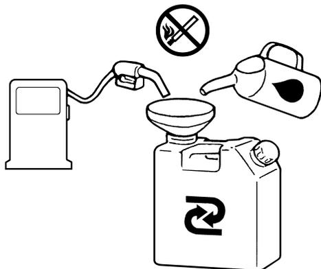
燃料は、最寄りのガソリンスタンドで「空冷2サイクルエンジン用混合ガソリン」をお求めになるか、自動車用無鉛ガソリンと空冷2サイクル専用FC級またはFD級オイルを左図割合で混合容器に入れ、容器を振ってよく混ぜ合わせたものを使用してください。
