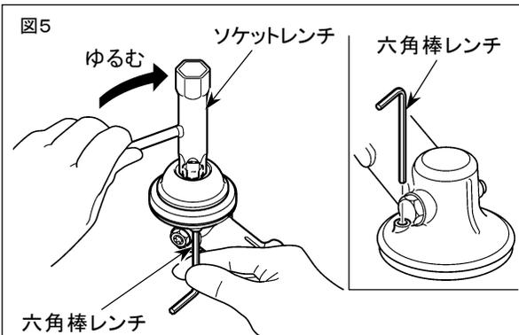
2. 刃受金具の固定穴とギヤケースの差込穴を合わせて付属品の六角棒レンチを差し込み、軸が回らないように固定してください。
