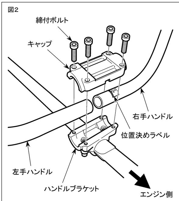
1. メインパイプに組み付けられているキャップ取付用の締付ボルト (M5×25) 4本を付属のソケットレンチでゆるめてください。
