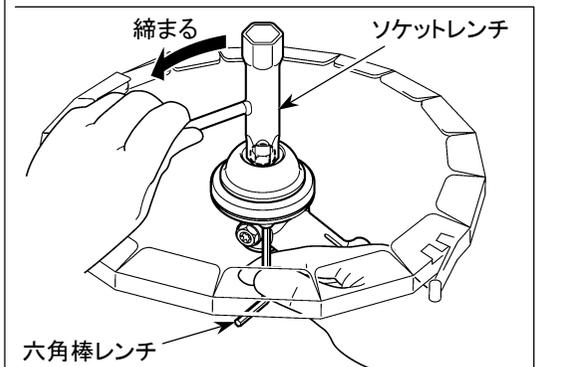
9. 六角棒レンチで回り止めをしてから、スプリングワッシャ付き刈刃取付ボルト（または刈刃取付ボルトにスプリングワッシャをはめて）をソケットレンチで反時計方向に回して確実に締め付けてください。
