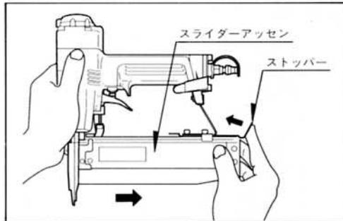
2 ネイルの足をマガジンの底につけ、側面の溝にネイルの頭を合わせてマガジンに入れます。
