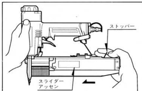
●スライダーアッセン横にネイル残量表示窓を設けています。ネイルの残りが少なくなりますと、窓に白い樹脂が出てきます。新しいネイルを準備して下さい。
