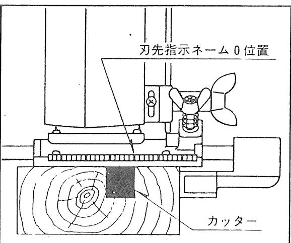
※カッターが摩耗した場合には、刃先指示ネームを固定している2本のビスをゆるめ、0位置をカッターの内側面に合わせて下さい。
