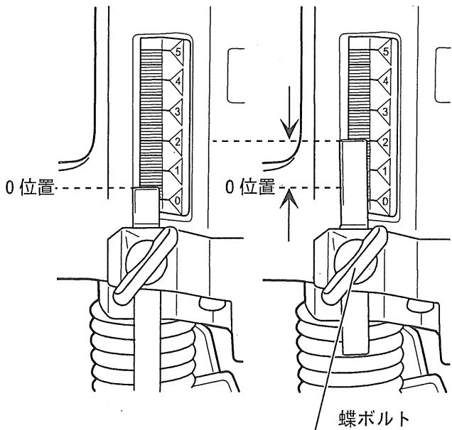
● ストップブロックの3本のナベ小ネジを異なる高さに調整し、ストップブロックを回転させることにより、3種類の切込深さを簡単に調整できます。
