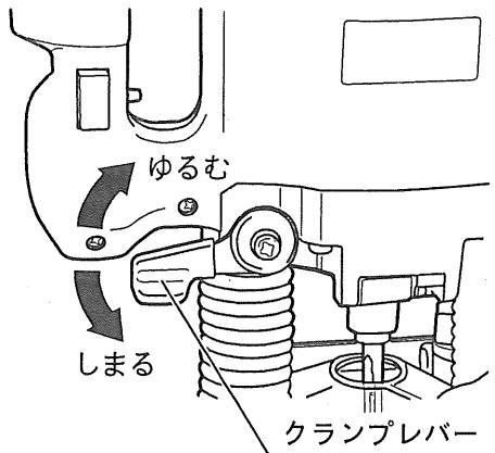
③ 両方のグリップを握り、ビットが材料の表面にふれるまで本体を押し下げ、クランプレバーを締付けます。この時の指針が切込深さ「0」となります。
