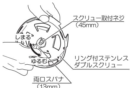
スピンドルを両口スパナの17mm側で固定し、スクリュー取付ネジの六角部を両口スパナの13mm側で締付けてください。
