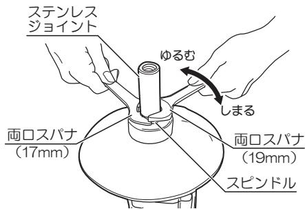
2. ステンレスシャフトをステンレスジョイントにねじ込み、付属品のスパナで締付けます。スピンドルを両口スパナの17mm側で固定し、ステンレスシャフトの六角部を両口スパナの19mm側で締付けてください。
