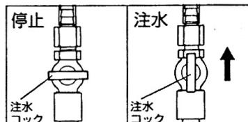
又注水パイプ取付けステーの蝶ナットをゆるめて注水方向を確認し調整してください。
