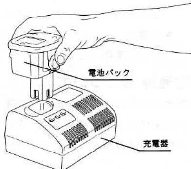
3. 黄色と緑色のランプが一瞬点灯し、赤色のランプが点灯します。これは、充電中であることを示しています。標準充電時間は60分です。充電が完了しましたら、赤色のランプが消えて、緑色のランプが点灯しますので、電池パックを充電器から抜いてください。
