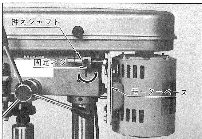
(注)必ずチャック側ブーリーとモーター側ブーリーとの間でベルトが平行(水平)に掛るようにして下さい。
