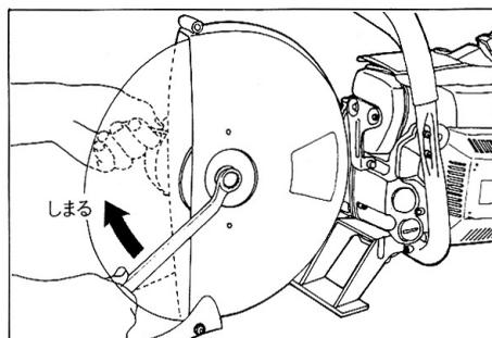
振れや揺れがあるときは、カッタブレードが確実にフランジの座に入っていないか、フランジボルトの締付けがゆるいことが考えられます。
