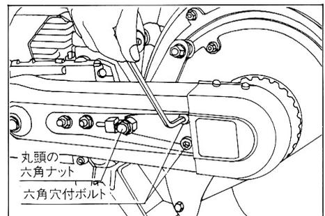
テンションボルトを受けている丸頭の六角ナットをゆるめます。
