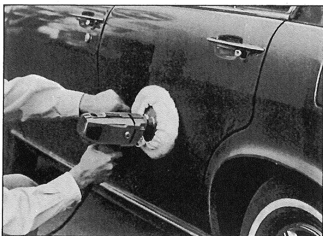
B. スムーズパットに羊毛ボンネット(163mm)で直接包んでもワックス仕上げが出来ます。図(B)
