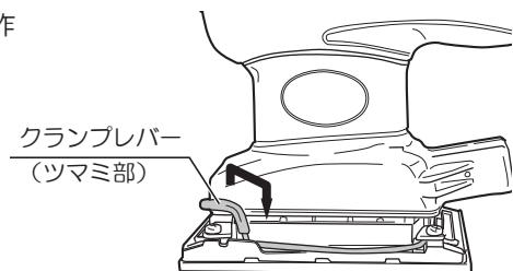
3. クランプに木工ペーパーをさし込み、クランプレバーを元の位置に戻し、クランプを閉じます。
