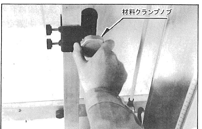
⑤足踏式スイッチのペダルを踏んでモーターを回転させ、取手を押し上げて切断して下さい。2種類の取手は材料高さに応じて使い分けて下さい。
