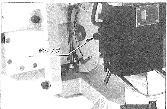
②定規を横目盛の切断する寸法にセットして下さい。
