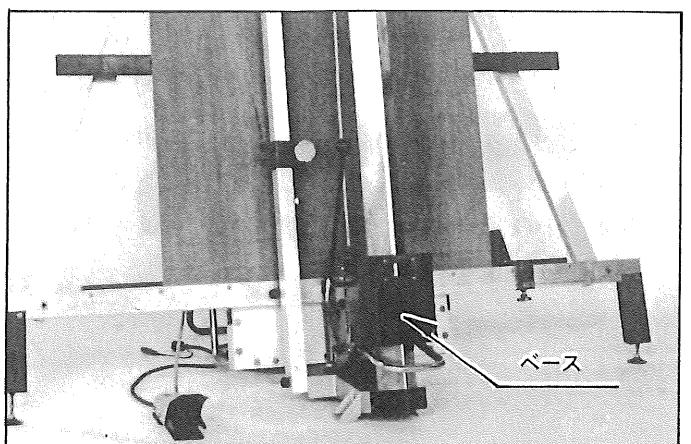
④材料を定規に止まる迄入れて、材料クランプノブを締付けて材料を固定して下さい。
