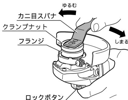
3. フランジに砥石、クランプナットを取付け、ロックボタンでスピンドルを固定し、カニ目スパナで矢印(しまる)の方向に回し締付けます。このとき、砥石の中央穴にクランプナットの凸の座が正確に入るように合わせてください。
