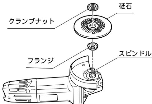
4. ロックボタンを押さえていた手をゆるめ、ロックボタンがもとの位置に戻り、砥石が手で回せることを確認してください。砥石を回すことにより、スピンドルの固定が解除されたことを確認できます。
