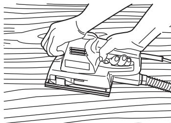
(注) 無理に強く押しつけて作業しないでください。無理に押しつけて研磨すると、均一な仕上げ面が得られないだけでなく、ペーパーの破れや本体故障の原因になります。
