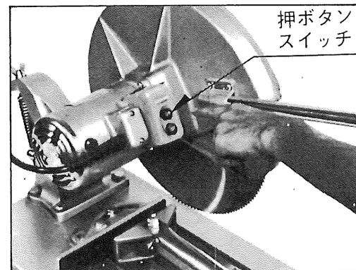
● ハンドルを下げると丸ノコを覆っている安全カバーが上ります。切断作業が終了するとハンドルを上げると自動的に安全カバーが丸ノコを覆い安全な作業が出来ます。
