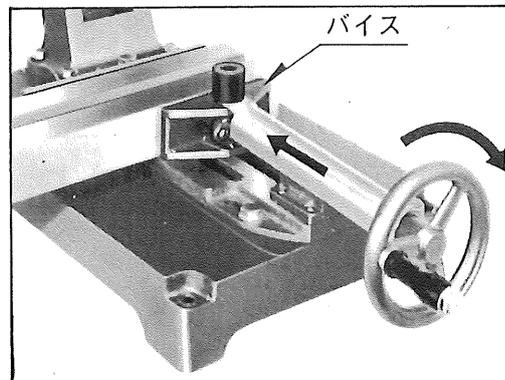
● 加工材を固定したらスイッチ(ON)を押してハンドルを静かに下ろして加工して下さい。
