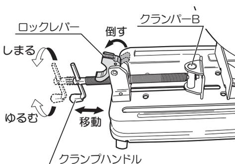
2. クランプ A、B の間に切断材料を置きます。
