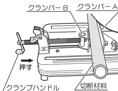
4. ロックレバーを矢印方向に起こし（ネジ部が下向）、クランプハンドルを矢印(しまる)方向に回してクランプ B で材料を締付けます。
