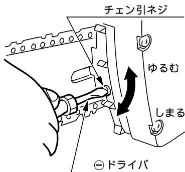
3. ソーチェーンの張りはガイドバーの中ほどでソーチェーンを軽く指で引上げ、ドライブリンクの底がガイドバーから1～2mm離れる程度に調整してください。
