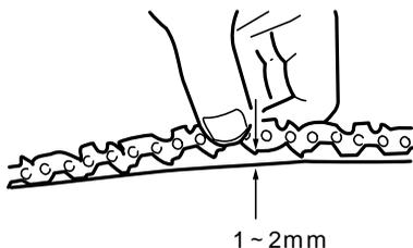
4. 調整後は付属品のスパナでナットを強く締付けてください。
