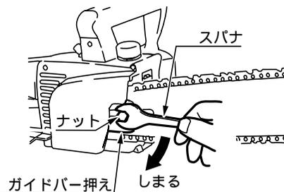
(注) 新品時のソーチェーンは多少の伸びがありますので、少し使用ののち、点検をしてください。必ず電源からプラグを抜いて調整を行なってください。
