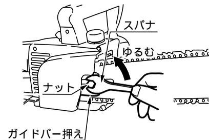
2. 付属品の ⊖ドライバーでチェーン引ネジを回し、ソーチェーンの張りを調整します。チェーン引ネジを右の回すとソーチェーンは張り、左に回すとゆるみます。
