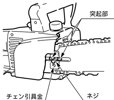
4. ガイドバーの取付穴（6 mm穴）にチェーン引金具が入らない時は、付属品の ⊖ドライバーでチェーン引ネジを調整した後、ガイドバーをセットしてください。
